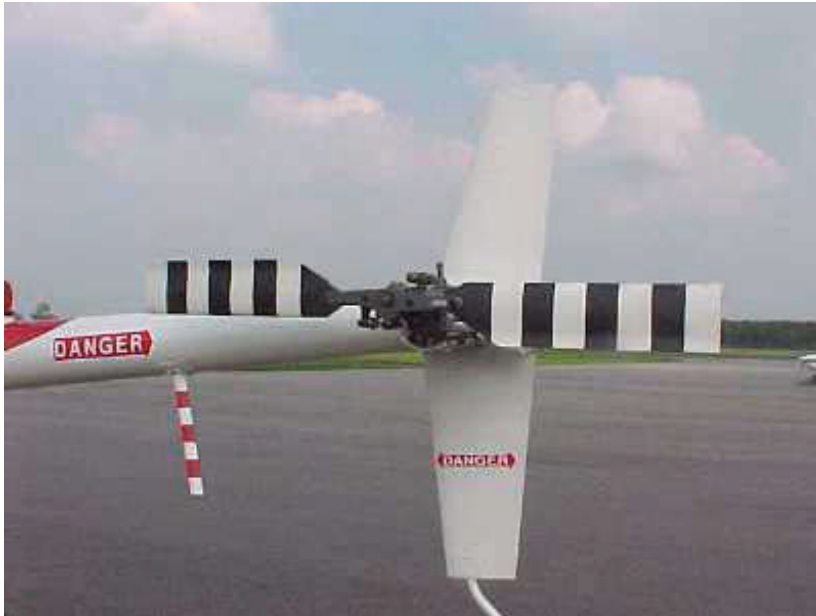
As pás do rotor de cauda tem somente 61 cm de comprimento
