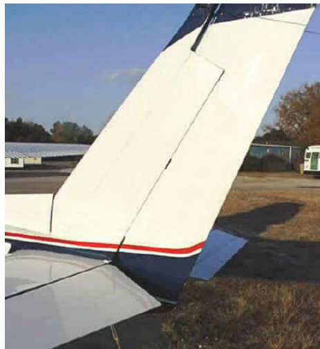
Asa vertical (estabilizador e leme) na cauda
