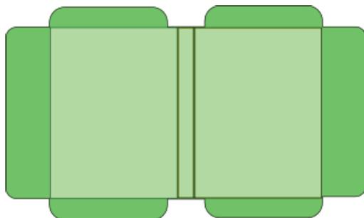
**Corte um retângulo de plástico grosso, excedendo as dimensões do livro aberto em 4cm, faça os cortes na direção da lombada e nos cantos da capa conforme a figura.**
